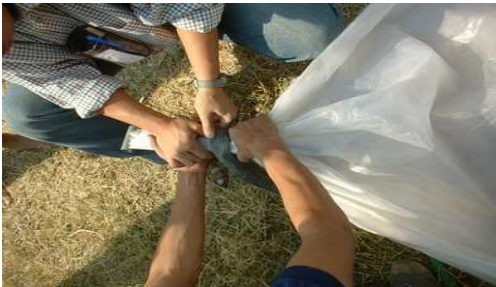
นำถุงพลาสติกอีกใบหนึ่งมัดปิดปลายข้างหนึ่งให้แน่น ส่วนปลายอีกข้างหนึ่งนำข้อต่อสามทางมาได้ แล้วมัดให้แน่นด้วยยางในรถ ถุงพลาสติกนี้จะทำหน้าที่เป็นตัวเก็บก๊าซ
